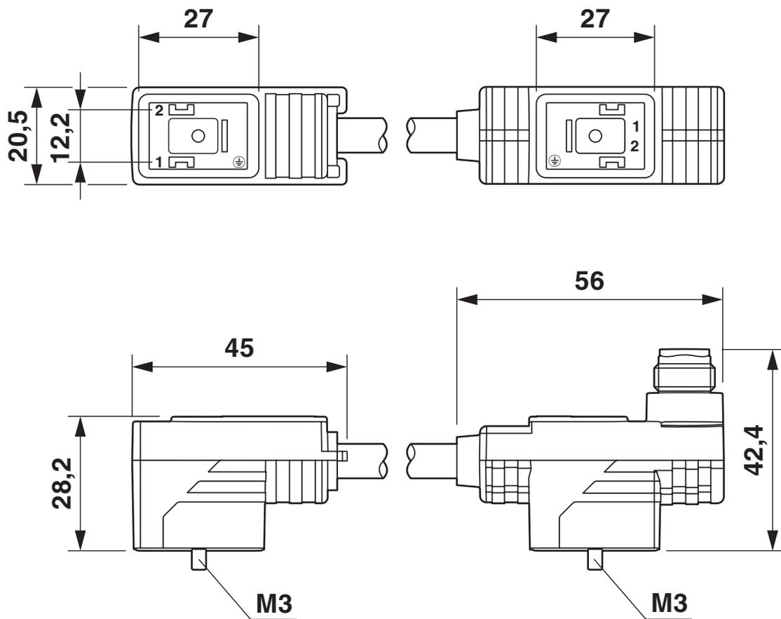
Doppelventilstecker, 2x Bauform B
