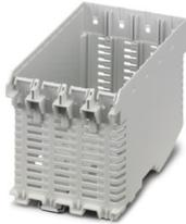
Tragschienengehäuse, Gehäuseunterteil mit Metallfußriegel, mit Lüftungsschlitzen, Breite: 75,87 mm, Höhe: 120,6 mm, Tiefe: 82,85 mm, Farbe: lichtgrau (ähnlich RAL 7035), Querverbindung: Tragschienen-Busverbinder (optional), Polzahl Querverbinder: 5 oder 8
