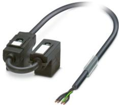
Doppelventilstecker-Kabel, 4-polig, PUR/PVC, schwarz, freies Leitungsende, auf Ventilstecker B (10 mm), mit 1 LED, Beschaltung: Z-Diode und Ventilstecker B (10 mm), mit 1 LED, Beschaltung: Z-Diode, Kabellänge: 3 m, Ventilsteckerabstand: 0,2 m
