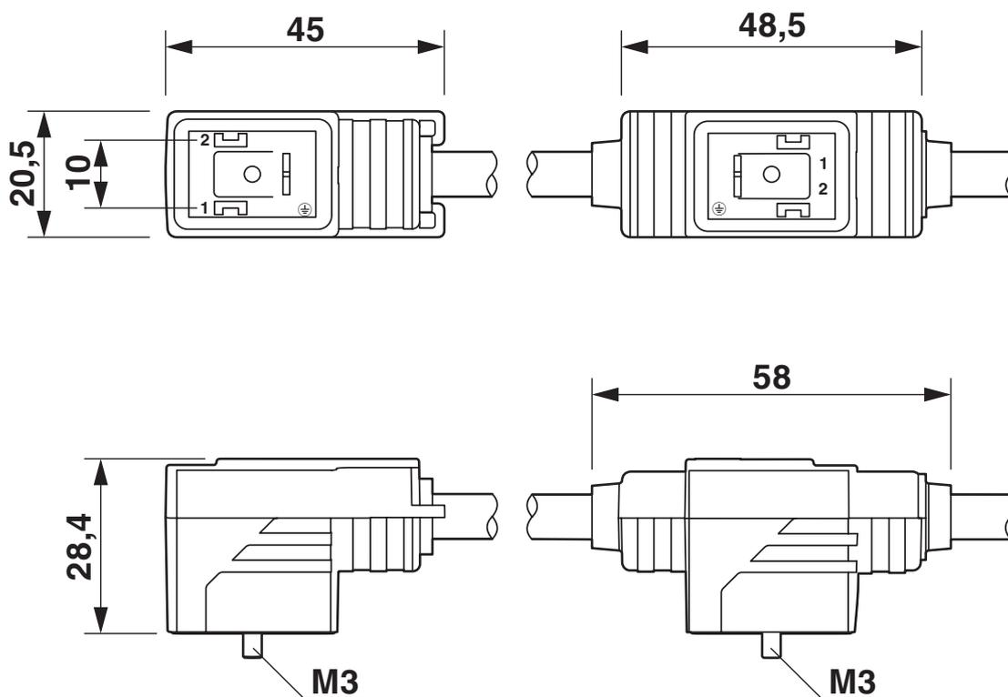
Doppelventilstecker, 2x Bauform B
