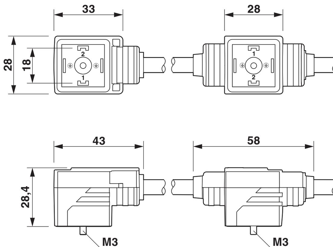
Doppelventilstecker, 2x Bauform A
