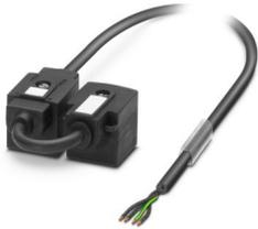
Doppelventilstecker-Kabel, 4-polig, PUR/PVC, schwarz, freies Leitungsende, auf Ventilstecker A, mit 1 LED, Beschaltung: Z-Diode und Ventilstecker A, mit 1 LED, Beschaltung: Z-Diode, Kabellänge: 1,5 m, Ventilsteckerabstand: 0,15 m
