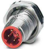
Gerätesteckverbinder Hinterwand, 4-polig, Stift, gerade, M12-SPEEDCON, D-Kodierung, Wellenlöten, dieser Artikel ist voraussichtlich ab 2026-Q1 nach RoHS II ohne Ausnahme 6c (Pb < 0,1 %) bleifrei, auf Anfrage ist eine bleifreie Alternative vorab möglich
