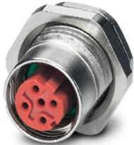
Gerätesteckverbinder Hinterwand, 4-polig, Buchse, gerade, M12-SPEEDCON, D-Kodierung, Wellenlöten, dieser Artikel ist voraussichtlich ab 2026-Q1 nach RoHS II ohne Ausnahme 6c (Pb < 0,1 %) bleifrei, auf Anfrage ist eine bleifreie Alternative vorab möglich
