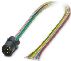
Kontaktträger, 8-polig, Stift, gerade, M12, A-Kodierung, auf freies Leitungsende, Einzellitzen, Kabellänge: 0,5 m, 0,25 mm<sup>2</sup>, TPE-Litze, dieser Artikel ist voraussichtlich ab 2025-Q4 nach RoHS II ohne Ausnahme 6c (Pb < 0,1 %) bleifrei, auf Anfrage ist eine bleifreie Alternative vorab möglich
