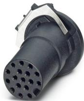
Kontaktträger, 17-polig, Buchse, gerade, M12, A-Kodierung, THR-Lötanschluss, dieser Artikel ist voraussichtlich ab 2025-Q3 nach RoHS II ohne Ausnahme 6c (Pb < 0,1 %) bleifrei, auf Anfrage ist eine bleifreie Alternative vorab möglich
