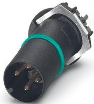
Kontaktträger, 4-polig, Stift, gerade, M12, A-Kodierung, THR-Lötanschluss, Artikel ist bleifrei nach RoHS II ohne Ausnahme 6c (Pb < 0,1 %)
