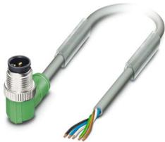
Sensor-/Aktor-Kabel, 5-polig, PUR halogenfrei, schweißfunkenbeständig, hochflexibel, grau RAL 7001, Stecker gewinkelt M12, Kodierung: A, auf freies Leitungsende, Kabellänge: 5 m, für Roboter und Schleppketten
