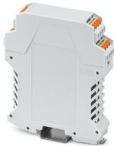
Tragschienengehäuse, zur Montage auf Tragschiene, geschlossenes Gehäuseoberteil, Farbe: lichtgrau (ähnlich RAL 7035), Breite: 22,6 mm, Höhe: 99 mm, Tiefe: 113,65 mm, einschl. 4 Stück Leiterplattenstecker, 4-polig, Push-in-Federanschluss, für 2,5 mm<sup>2</sup>, Nennstrom: 12 A, 320 V, Leiterplattenfläche: 7800 mm<sup>2</sup>
