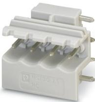
Leiterplatten-Grundleiste, Nennquerschnitt: 2,5 mm<sup>2</sup>, Farbe: lichtgrau, Nennstrom: 12 A, Bemessungsspannung (III/2): 320 V, Kontaktoberfläche: Sn, Kontaktart: Stift, Anzahl der Reihen: 1, Polzahl: 4, Artikelfamilie: MSTBO 2,5/...-G1R, Anschlussart: steckbar, Montage: Wellenlöten, Anzahl der Lötpins pro Potenzial: 1, Stecksystem: COMBICON MSTB 2,5, Ausrichtung Steckgesicht: Orthogonal, Verriegelung: ohne, Artikel mit seitlichem Pinabgang rechts
