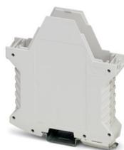
Tragschienengehäuse, Gehäuseunterteil mit Metallfußriegel, mit FE-Kontakt, hohe Bauform, mit Lüftungsschlitzen, Breite: 22,6 mm, Höhe: 99 mm, Tiefe: 107,3 mm, Farbe: lichtgrau (ähnlich RAL 7035), Querverbindung: Tragschienen-Busverbinder (optional), Polzahl Querverbinder: 5
