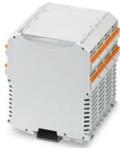
Tragschienengehäuse, zur Montage auf Tragschiene, Farbe: lichtgrau (ähnlich RAL 7035), Breite: 90,4 mm, Höhe: 99 mm, Tiefe: 113,65 mm, einschl. 16 Stück Leiterplattenstecker, 4-polig, Schraubanschluss, für 2,5 mm<sup>2</sup>, Nennstrom: 12 A, 320 V, Leiterplattenfläche: 7500 mm<sup>2</sup>
