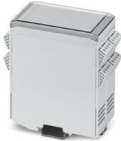
Tragschienengehäuse, zur Montage auf Tragschiene, mit transparenter Schwenkdeckel, Farbe: lichtgrau (ähnlich RAL 7035), Breite: 50,1 mm, Höhe: 100 mm, Tiefe: 116,7 mm, einschl. 8 Stück Leiterplattenstecker, 4-polig, Schraubanschluss, für 2,5 mm<sup>2</sup>, Nennstrom: 16 A, 320 V, Leiterplattenfläche: 9600 mm<sup>2</sup>
