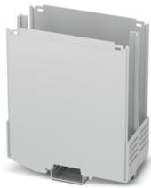
Tragschienengehäuse, Gehäuseunterteil mit Metallfußriegel, Etage 1: mit Lüftungsschlitzen, Breite: 50,1 mm, Höhe: 100 mm, Tiefe: 108,35 mm, Farbe: lichtgrau (ähnlich RAL 7035), Querverbindung: Tragschienen-Busverbinder (optional), Polzahl Querverbinder: 8
