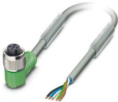
Sensor-/Aktor-Kabel, 5-polig, PUR halogenfrei, schweißfunkenbeständig, hochflexibel, grau RAL 7001, freies Leitungsende, auf Buchse gewinkelt M12, Kodierung: A, Kabellänge: 3 m, für Roboter und Schleppketten
