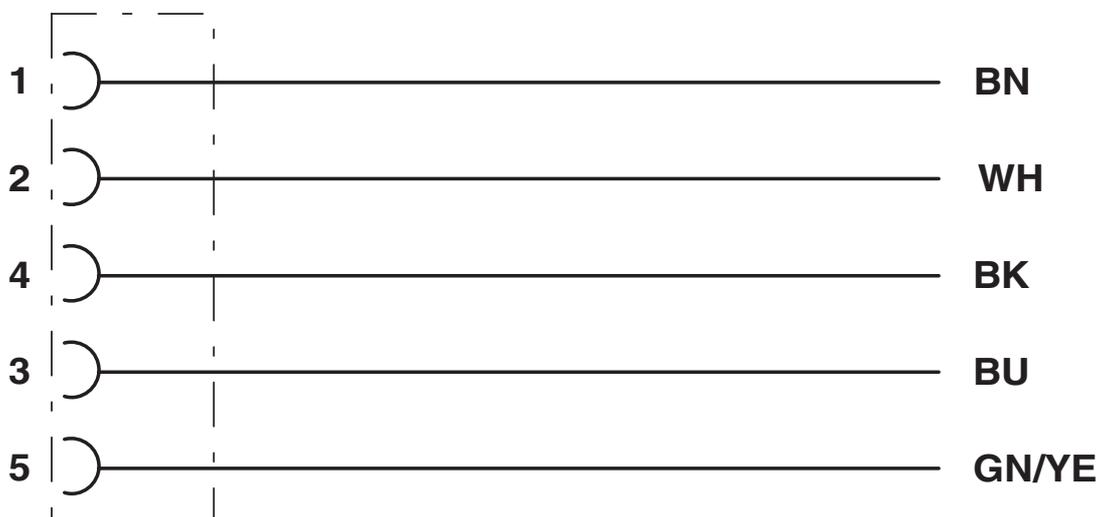
Kontaktbelegung der M12-Buchsen
