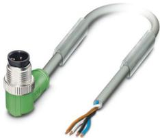
Sensor-/Aktor-Kabel, 4-polig, PUR halogenfrei, schweißfunkenbeständig, hochflexibel, grau RAL 7001, Stecker gewinkelt M12, Kodierung: A, auf freies Leitungsende, Kabellänge: 5 m, für Roboter und Schleppketten
