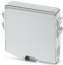
Tragschienengehäuse, zur Montage auf Tragschiene, mit transparenter Schwenkdeckel, Farbe: lichtgrau (ähnlich RAL 7035), Breite: 20 mm, Höhe: 100 mm, Tiefe: 116,6 mm, einschl. 4 Stück Leiterplattenstecker, 3-polig, Schraubanschluss, für 2,5 mm<sup>2</sup>, Nennstrom: 16 A, 320 V, Leiterplattenfläche: 9600 mm<sup>2</sup>
