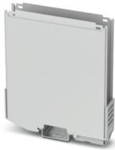
Tragschienengehäuse, Gehäuseunterteil mit Metallfußriegel, Etage 1: mit Lüftungsschlitzen, Breite: 20 mm, Höhe: 100 mm, Tiefe: 108,35 mm, Farbe: lichtgrau (ähnlich RAL 7035), Querverbindung: Tragschienen-Busverbinder (optional), Polzahl Querverbinder: 8
