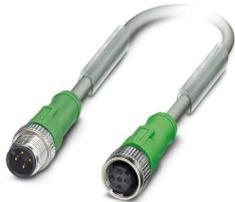
Sensor-/Aktor-Kabel, 4-polig, PUR halogenfrei, schweißfunkenbeständig, hochflexibel, grau RAL 7001, Stecker gerade M12, Kodierung: A, auf Buchse gerade M12, Kodierung: A, Kabellänge: 3 m, für Roboter und Schleppketten
