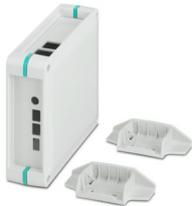
Komplettgehäuse für Raspberry Pi Leiterplatten. Beinhaltet Gehäusehalbschalen, Seitenwände mit Öffnungen für alle relevanten Anschlüsse, Klebedome zur Befestigung des Raspberry Pi Model B4 Computers, Schrauben für Gehäuse und Platinenbefestigung; Gehäusefarbe lichtgrau mit Eckenlegern türkisblau
