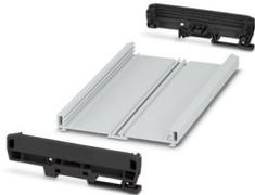
Profilgehäuse (PA), Montageart: Tragschienenmontage, Maße auf Tragschiene: Breite: 203,8 mm, Höhe: 142,3 mm, Tiefe: 39,45 mm, einschl. 2 Seitenelemente (PA), Farbe: schwarz (9005), für Leiterplatten mit Breite: 122 mm, Länge: 200 mm, Leiterplattenfläche: 21590 mm<sup>2</sup>
