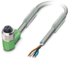
Sensor-/Aktor-Kabel, 4-polig, PUR halogenfrei, schweißfunkenbeständig, hochflexibel, grau RAL 7001, freies Leitungsende, auf Buchse gewinkelt M12, Kodierung: A, Kabellänge: 10 m, für Roboter und Schleppketten
