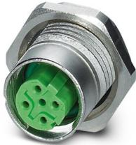
Gerätesteckverbinder Hinterwand, 4-polig, Buchse, gerade, M12-SPEEDCON, D-Kodierung, Wellenlöten, dieser Artikel ist voraussichtlich ab 2026-Q1 nach RoHS II ohne Ausnahme 6c (Pb < 0,1 %) bleifrei, auf Anfrage ist eine bleifreie Alternative vorab möglich
