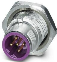
Gerätesteckverbinder Hinterwand, 5-polig, Stift, gerade, M12-SPEEDCON, B-Kodierung, Wellenlöten, dieser Artikel ist voraussichtlich ab 2026-Q1 nach RoHS II ohne Ausnahme 6c (Pb < 0,1 %) bleifrei, auf Anfrage ist eine bleifreie Alternative vorab möglich
