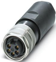
Steckverbinder, Universal, 5-polig, Buchse gerade 7/8"-16UNF, Kodierung: A, Schraubanschluss, Rändelmaterial: Zinkdruckguss, vernickelt, Kabelverschraubung Pg11, Leitungsaußendurchmesser 8 mm ... 10 mm
