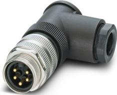
Steckverbinder, Universal, 5-polig, Stecker gewinkelt 7/8"-16UNF, Kodierung: A, Schraubanschluss, Rändelmaterial: Zinkdruckguss, vernickelt, Kabelverschraubung Pg13,5, Leitungsaußendurchmesser 10 mm ... 12 mm, Kontakt 3 voreilend
