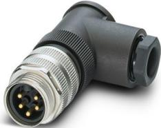
Steckverbinder, Universal, 5-polig, Stecker gewinkelt 7/8"-16UNF, Kodierung: A, Schraubanschluss, Rändelmaterial: Zinkdruckguss, vernickelt, Kabelverschraubung Pg11, Leitungsaußendurchmesser 8 mm ... 10 mm, Kontakt 3 voreilend
