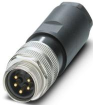
Steckverbinder, Universal, 5-polig, Stecker gerade 7/8"-16UNF, Kodierung: A, Schraubanschluss, Rändelmaterial: Zinkdruckguss, vernickelt, Kabelverschraubung Pg16, Leitungsaußendurchmesser 12 mm ... 14 mm, Kontakt 3 voreilend
