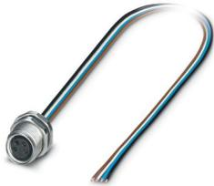
Gerätesteckverbinder Hinterwand, 4-polig, Buchse, gerade, M8, A-Kodierung, auf freies Leitungsende, Einzellitzen, Kabellänge: 0,5 m, 0,25 mm<sup>2</sup>, PVC-Litze
