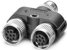
Y-Verteiler, 8-polig, geschirmt, Stecker gerade M12 SPEEDCON, Kodierung: A, auf Buchse gerade M12 SPEEDCON, Kodierung: A und Buchse gerade M12 SPEEDCON, Kodierung: A, parallel Verteiler
