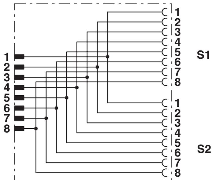
Kontaktbelegung des M12-Y-Verteilers
