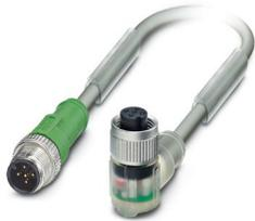
Sensor-/Aktor-Kabel, 5-polig, PUR halogenfrei, schweißfunkenbeständig, hochflexibel, grau RAL 7001, Stecker gerade M12, Kodierung: A, mit 3 LEDs, auf Buchse gewinkelt M12, Kodierung: A, mit 3 LEDs, Kabellänge: 0,6 m, für Roboter und Schleppketten
