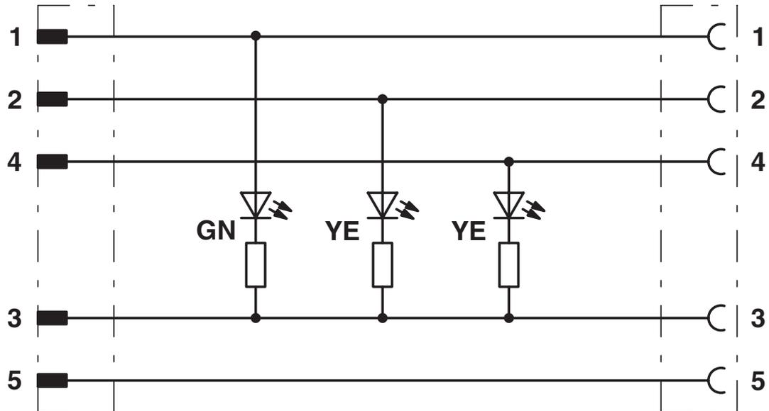
Kontaktbelegung der M12-Stecker / Buchsen mit LED
