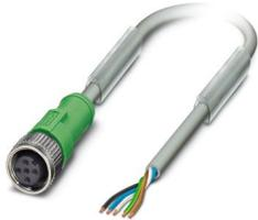
Sensor-/Aktor-Kabel, 5-polig, PUR halogenfrei, schweißfunkenbeständig, hochflexibel, grau RAL 7001, freies Leitungsende, auf Buchse gerade M12, Kodierung: A, Kabellänge: 10 m, für Roboter und Schleppketten
