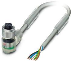
Sensor-/Aktor-Kabel, 5-polig, PUR halogenfrei, schweißfunkenbeständig, hochflexibel, grau RAL 7001, freies Leitungsende, auf Buchse gewinkelt M12, Kodierung: A, mit 3 LEDs, Kabellänge: 10 m, für Roboter und Schleppketten
