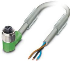
Sensor-/Aktor-Kabel, 3-polig, PUR halogenfrei, schweißfunkenbeständig, hochflexibel, grau RAL 7001, freies Leitungsende, auf Buchse gewinkelt M12, Kodierung: A, Kabellänge: 5 m, für Roboter und Schleppketten
