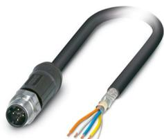
Netzwerkkabel, Ethernet CAT5 (100 MBit/s), PROFINET CAT5 (100 MBit/s), 4-polig, PE-X halogenfrei, schwarz RAL 9005, geschirmt, Stecker gerade M12, Kodierung: D / IP69K, auf freies Leitungsende, Kabellänge: 10 m, für Außenanwendungen, mit Edelstahlrändel
