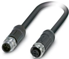
Sensor-/Aktor-Kabel, 4-polig, PE-X/PE-X halogenfrei, schwarzgrau RAL 7021, geschirmt, Stecker gerade M12, Kodierung: A, auf Buchse gerade M12, Kodierung: A, Kabellänge: 2 m, für Außenanwendungen, mit Edelstahlrändel
