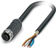
Sensor-/Aktor-Kabel, 4-polig, PE-X/PE-X halogenfrei, schwarzgrau RAL 7021, geschirmt, freies Leitungsende, auf Buchse gerade M12, Kodierung: A, Kabellänge: 5 m, für Außenanwendungen, mit Edelstahlrändel
