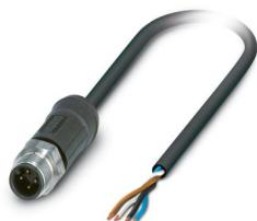
Sensor-/Aktor-Kabel, 4-polig, PE-X halogenfrei, schwarzgrau RAL 7021, Stecker gerade M12, Kodierung: A, auf freies Leitungsende, Kabellänge: 10 m, für Außenanwendungen, mit Edelstahlrändel
