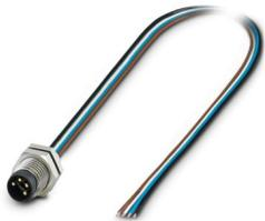
Gerätesteckverbinder Hinterwand, 4-polig, Stift, gerade, M8, A-Kodierung, auf freies Leitungsende, Einzellitzen, Kabellänge: 0,5 m, 0,25 mm<sup>2</sup>, PVC-Litze
