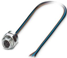
Gerätesteckverbinder Hinterwand, 3-polig, Buchse, gerade, M8, A-Kodierung, auf freies Leitungsende, Einzellitzen, Kabellänge: 0,5 m, 0,25 mm<sup>2</sup>, PVC-Litze
