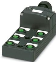
Verteilerbox, Anwendung: Standard, Anschlussart: M12-Buchse Kunststoff, Anzahl der Steckplätze: 6, Polzahl: 4, Kodierung: A, Steckplatzbelegung: einfach, Statusanzeige: ja, PNP; Stammleitungsanschluss: Federkraftanschluss 180°, Schirmung: nein
