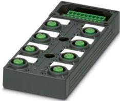
Grundgehäuse-Verteilerbox, Anwendung: Standard, Anschlussart: M12-Buchse Kunststoff, Anzahl der Steckplätze: 8, Polzahl: 4, Kodierung: A, Steckplatzbelegung: einfach, Statusanzeige: ja, PNP; Stammleitungsanschluss: Steckbarer Schraubanschluss, Schirmung: nein
