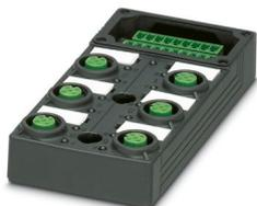
Grundgehäuse-Verteilerbox, Anwendung: Standard, Anschlussart: M12-Buchse Kunststoff, Anzahl der Steckplätze: 6, Polzahl: 5, Kodierung: A, Steckplatzbelegung: doppelt, Statusanzeige: ja, PNP; Stammleitungsanschluss: Steckbarer Schraubanschluss, Schirmung: nein
