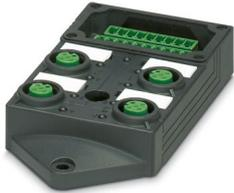
Grundgehäuse-Verteilerbox, Anwendung: Standard, Anschlussart: M12-Buchse Kunststoff, Anzahl der Steckplätze: 4, Polzahl: 5, Kodierung: A, Steckplatzbelegung: doppelt, Statusanzeige: ja, PNP; Stammleitungsanschluss: Steckbarer Schraubanschluss, Schirmung: nein
