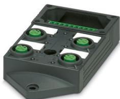
Grundgehäuse-Verteilerbox, Anwendung: Standard, Anschlussart: M12-Buchse Kunststoff, Anzahl der Steckplätze: 4, Polzahl: 4, Kodierung: A, Steckplatzbelegung: einfach, Statusanzeige: ja, PNP; Stammleitungsanschluss: Steckbarer Schraubanschluss, Schirmung: nein
