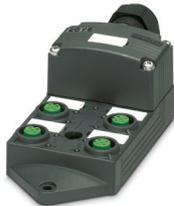
Verteilerbox, Anwendung: Standard, Anschlussart: M12-Buchse Kunststoff, Anzahl der Steckplätze: 4, Polzahl: 5, Kodierung: A, Steckplatzbelegung: doppelt, Statusanzeige: ja, PNP; Stammleitungsanschluss: Steckbarer Schraubanschluss 180°, Schirmung: nein
