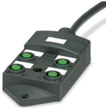
Verteilerbox, Anwendung: Standard, Anschlussart: M12-Buchse Kunststoff, Anzahl der Steckplätze: 4, Polzahl: 5, Kodierung: A, Steckplatzbelegung: doppelt, Statusanzeige: ja, PNP; Stammeitungsanschluss: Festanschluss 180°, PUR/PVC, Leitungslänge: 5 m, Schirmung: nein
