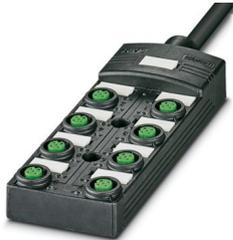
Verteilerbox, Anwendung: Standard, Anschlussart: M12-Buchse Kunststoff, Anzahl der Steckplätze: 8, Polzahl: 4, Kodierung: A, Steckplatzbelegung: einfach, Statusanzeige: nein, Universal; Stammleitungsanschluss: Festanschluss 180°, PUR/PVC, Leitungslänge: 5 m, Schirmung: nein
