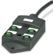
Verteilerbox, Anwendung: Standard, Anschlussart: M12-Buchse Kunststoff, Anzahl der Steckplätze: 4, Polzahl: 5, Kodierung: A, Steckplatzbelegung: doppelt, Statusanzeige: nein, Universal; Stammleitungsanschluss: Festanschluss 180°, PUR/PVC, Leitungslänge: 10 m, Schirmung: nein
