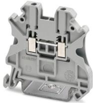
Durchgangsklemme, Nennspannung: 1000 V, Nennstrom: 17,5 A, Anzahl der Anschlüsse: 2, Anschlussart: Schraubanschluss, Bemessungsquerschnitt: 1,5 mm<sup>2</sup>, Querschnitt: 0,14 mm<sup>2</sup> - 1,5 mm<sup>2</sup>, Montageart: NS 35/7,5, NS 35/15, Farbe: grau
