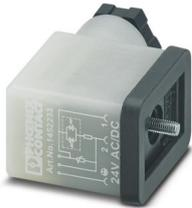
Ventilstecker, Universal, 3-polig, Ventilstecker BI (11 mm), Schraubanschluss, Kabelverschraubung M16, Leitungsaußendurchmesser 6 mm ... 8 mm
