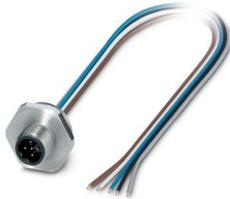
Gerätesteckverbinder Vorderwand, 5-polig, Stift, gerade, M12-Standard, B-Kodierung, auf freies Leitungsende, Einzellitzen, Kabellänge: 0,5 m, 0,34 mm<sup>2</sup>, TPE-Litze, vergossen
